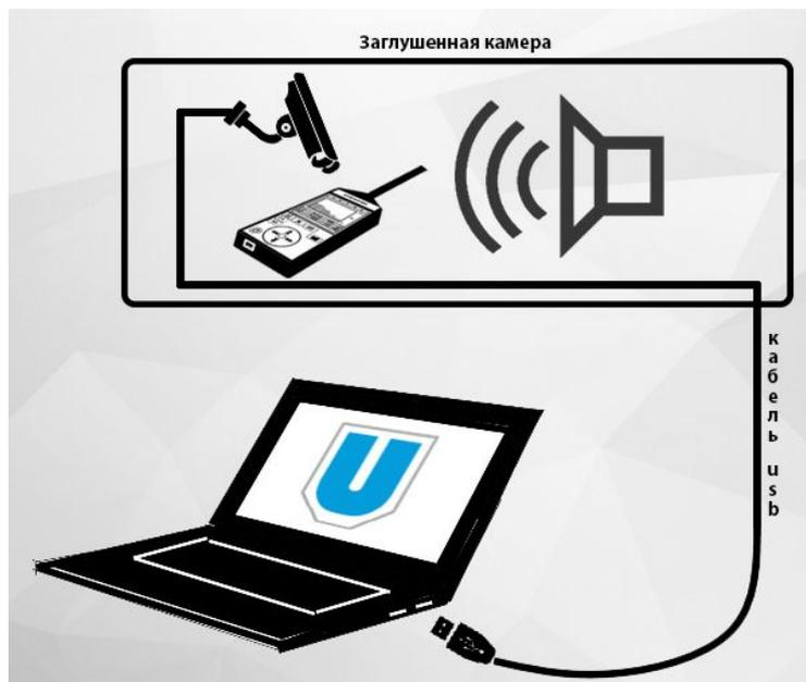
Рис. 2. Подключение видеокамеры к ПК.
