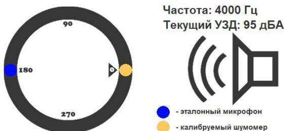
Для снятия показаний с калибруемого шумомера включите поворотное устройство в окне программы UniTesS JARD. Установите шумомер напротив источника звука.
