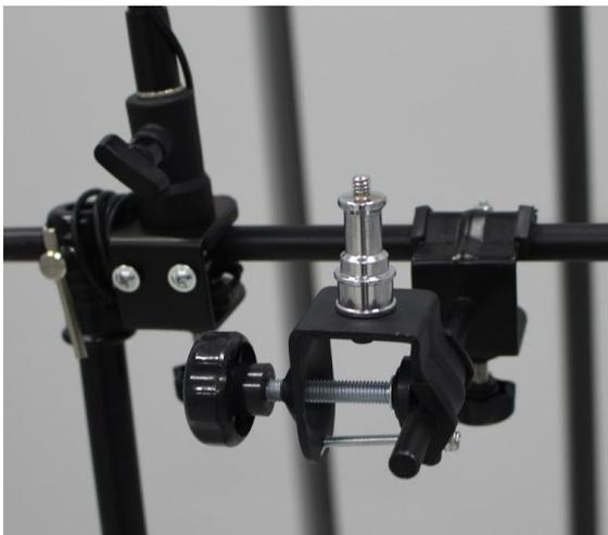
Рис. 7. Крепление для микрофона и шумомера.
