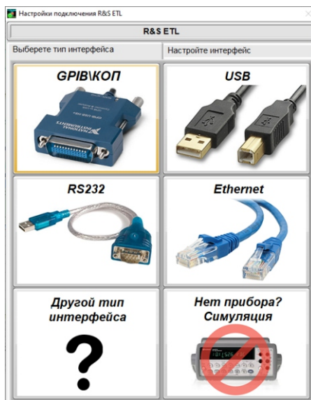
Рис.13 Выбор типа подключения оборудования
